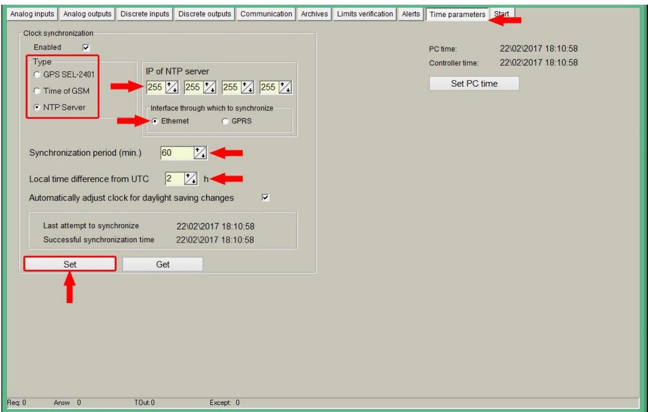
**Pic 10. Time Parameters tab. NTP server configuration**
