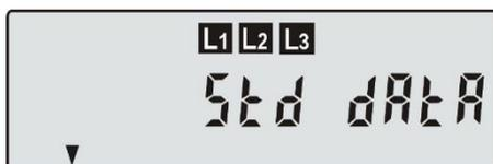
Par un appui long ( $2\text{ s} < T_p < 5\text{ s}$ ) sur le bouton poussoir bleu la première donnée de la liste « Manual Scroll » sera affichée sur l'afficheur. Un appui court ( $T_p < 2$  s) fait passer à la séquence d'affichage suivante.
