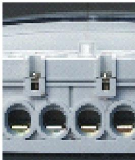
Fig. 16 Bouton du détecteur de l'ouverture du capot
