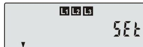
Par un appui long ( $2\text{ s} < T_p < 5\text{ s}$ ) sur le bouton poussoir bleu entrer dans le sous-menu du mode **SET**. Les options listées ci-dessous sont disponibles – passer à l'option suivante par un appui court ( $T_p < 2$  s) sur le bouton poussoir bleu:
